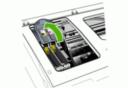
4. 拉開對應於控制面板訊息的印字頭扣栓，並用扣栓將印字頭拉出插槽。
