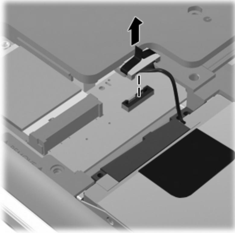
10. 將硬碟垂片往左拉 (1)，然後將硬碟從電腦抽離 (2)。
