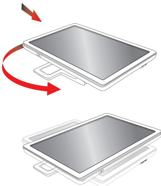
3. Segurando a base do monitor, levante o painel na parte superior sem tocar ou exercer pressão no ecrã (1).
