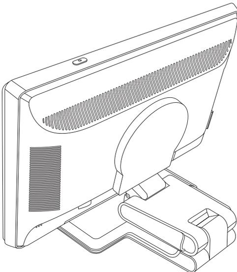
3. Coloque a fita de transporte em torno da base, puxe bem e ligue-a deslizando as extremidades da fita através dos calços.
