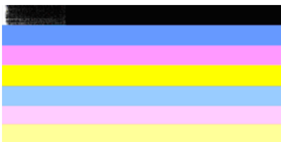
Příklad nesprávných barevných čar Černá čára je na jednom okraji roztřepená.
