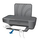
• 您可能需要打开托架门,将打印托架移到右侧以取出卡纸。
